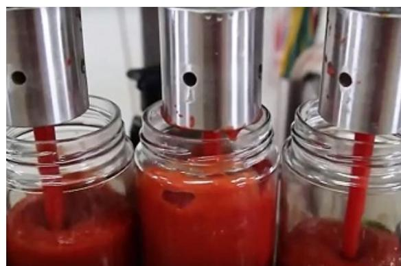
Il produttore dei contenitori Socojars, Socopet, ha brevettato il sistema SAF (Semi Aseptic Filling) per il miglioramento del processo di riempimento delle conserve alimentari, con particolare riferimento alla passata di pomodoro, frutto di una di ricerca al proprio interno e in collaborazione con Ssica (Stazione Sperimentale Industria Conserve Alimentari di Parma).
